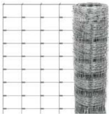
Especialmente diseñada para la construcción de cercos agrícolas y ganaderos. Se encuentra fabricada con alambre galvanizado con bajo contenido de carbono. Cuenta con uniones articuladas que permiten que la malla se adapte a las diversas variabilidades del terreno
